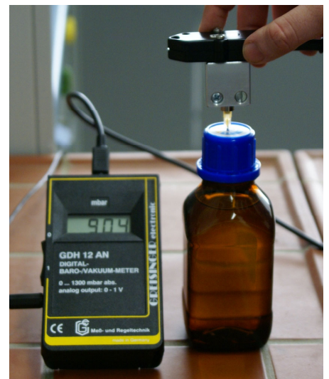
Messung des Gasdruckes Danach Direktdosierung in den Gaschromatographen
