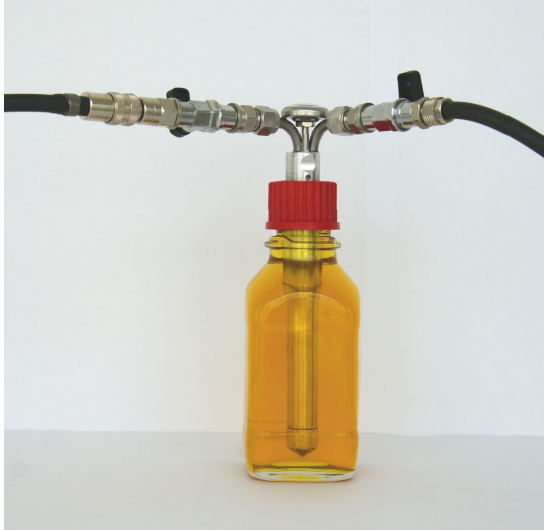
EGS-Füllvorgang Zirkulierender Ölfluß
